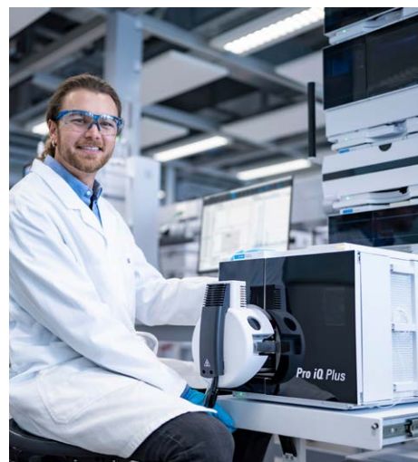
그림 10. 인출식 트레이에 Pro iQ Plus 질량 검출기가 장착된 Agilent InfinityLab Flex Bench MS.
