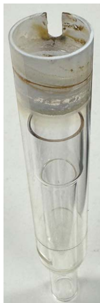
图 1. 石英外管组在分析含有 Li、Na、Cs 的 1.5% TDS 溶液 (5% \text{HNO}_3 介质) 24 小时后，发生失玻化
