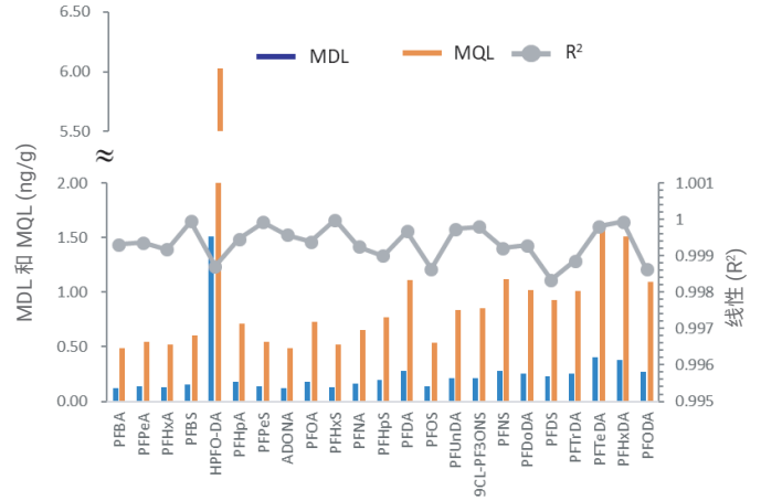
图 3. 所考察的 23 种 PFAS 化合物的 MDL、MQL 和线性 ( R^2 )
