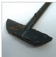
严重破损的 PTFE 涂层桨
