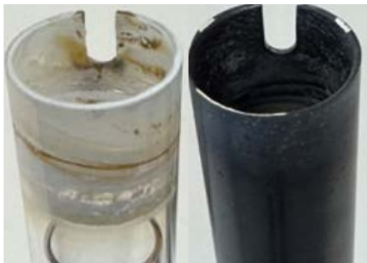
示例 2： 在分析 5% HNO 3 溶液中的 1.5% Li、Na、Cs 时，石英外管组（左）仅分析 24 小时后就出现明显的脱玻化，而陶瓷外管组（右）在分析超过 900 小时后仍展现出坚固性，未见明显降解
