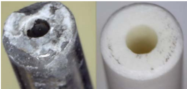
示例 1：使用氧化铝中心管测定废油样品中的磨损金属，证明了使用寿命的显著延长。在完成相同的分析和五次清洗循环后，石英中心管（左）已经降解，而氧化铝中心管（右）仍保持良好状态
