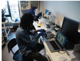
在实验室中使用 Cary 630 FTIR 进行大颗粒塑料样品定性分析
