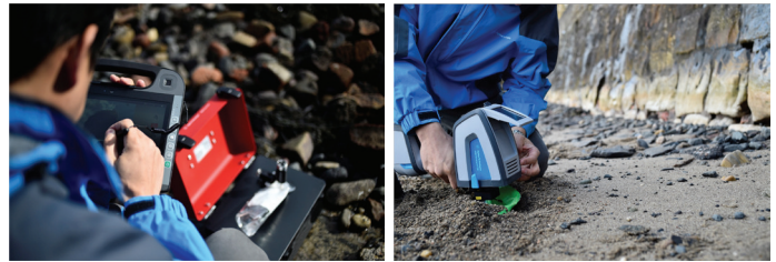
左图: Cary 4500 便携红外现场检测塑料样品 右图: Cary 4300 手持式红外检测塑料样品
