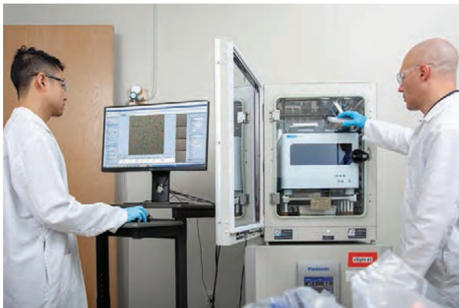
图 5. Agilent xCELLigence RTCA eSight 仪器及其工作站分别位于培养箱的内部和外部
