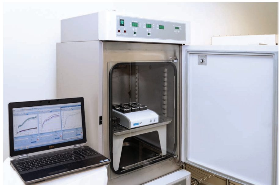
图 6. 在培养箱内直接进行活细胞分析。Agilent xCELLigence 仪器放置于标准培养箱或低氧室中，兼容全部生物学相关温度、大气成分和湿度范围
