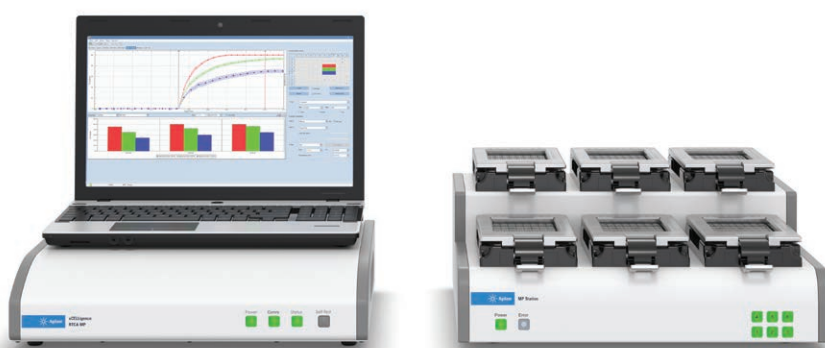
图 2. Agilent xCELLigence 仪器示意图。xCELLigence 仪器具有不同规格可供选择（16 孔、48 孔、96 孔和 576 孔）。所示仪器包含六个板位，每个板位中可搭载一个 96 孔电子微孔板。放置孔板的仪器部分放置于标准培养箱中，而分析仪和工作站（笔记本电脑）则放置于培养箱外。可以同时且相互独立地监测所有六个孔板，最大程度提高通量和灵活性
