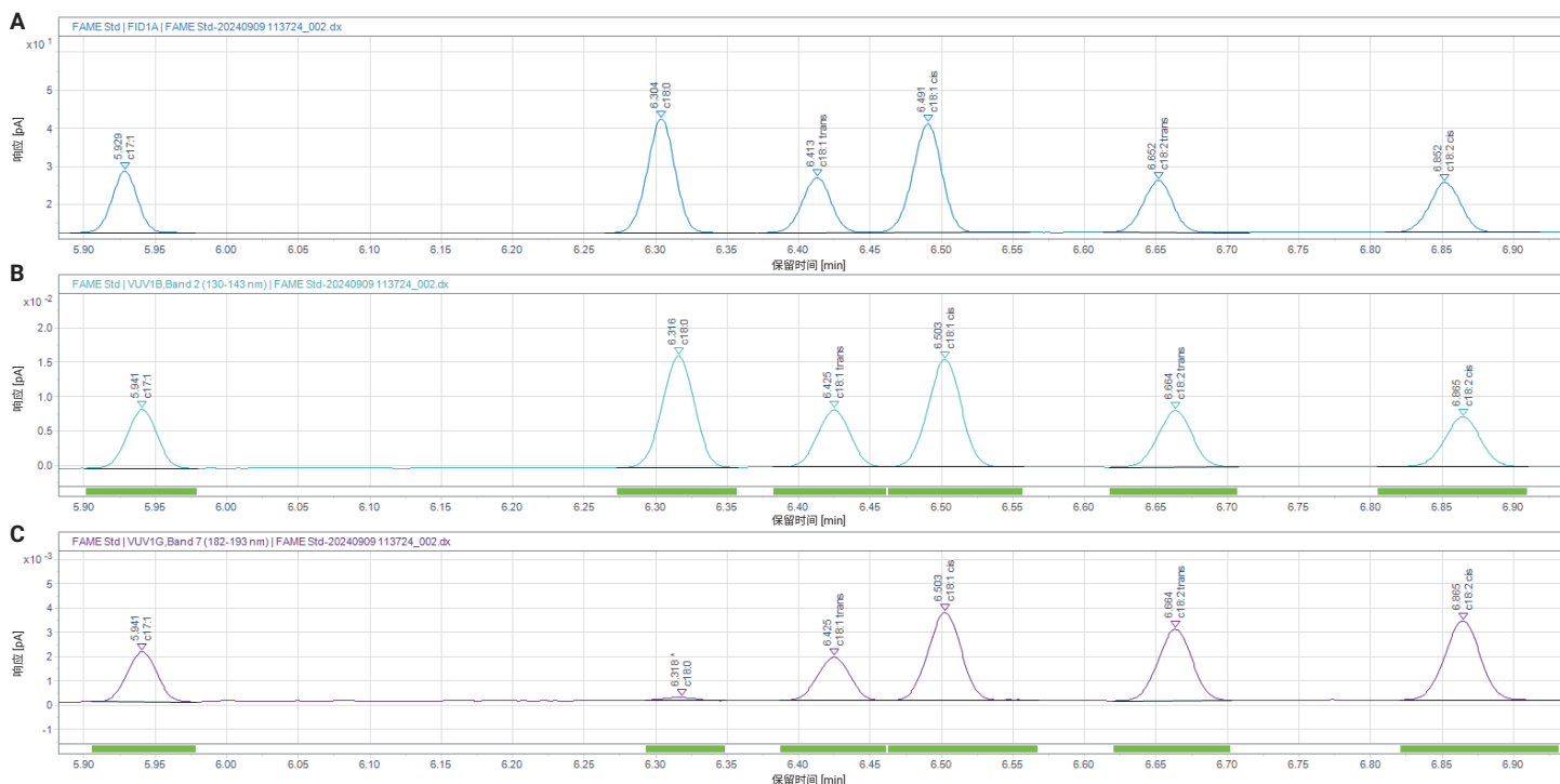
图 4. 通过 FID (A) 和 LUMA 波段 2 (B) 和 7 (C) 获得的纯标准品色谱图在 c17:1 至 c18:3n6 脂肪酸甲酯区域的放大图
